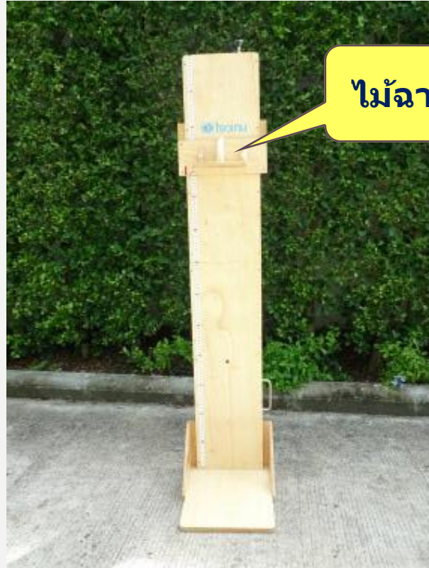
เครื่องวัดความยาว/ส่วนสูง ไม้ท่อนโป่ง ตัวเลขชัดเจน มีความละเอียด 0.1 เซนติเมตร และมีไม้ฉาก
